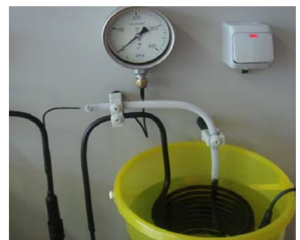
Verdampfer mit Niederdruckmanometer und Expansionsventil
