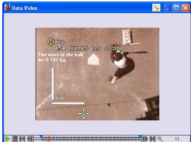
Abbildung 73. Bei der manuellen Videovermessung wird ein Sucher als Mauscursor verwendet, um das bewegende Objekt zu orten.
